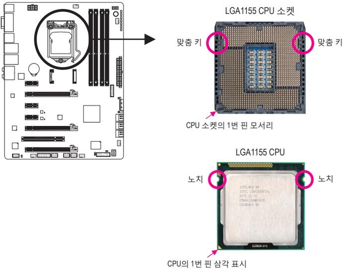
B. 아래 단계에 따라 메인보드 CPU 소켓에 CPU 를 올바르게 설치하십시오.
