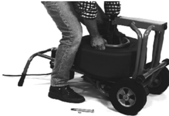
图20 — 安装鼓到支架上
