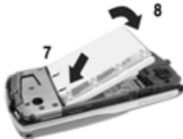
**注：**请按照图示操作以防损坏电池连接片。
