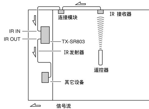
如下图所示，将 IR 发射器连接到 TX-SR803 的 IR OUT 插座。
