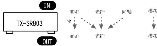
\* 如希望通过电视机的扬声器聆听通过 HDMI IN 1, 2 接口接收到的音频，须将 HDMI Audio Out 设置为 On（见 75 页）。注意某些音频（如 DVD 音频）可能无法由电视输出。而且，电视不支持的音频格式和采样率也无法输出。确认您的 DVD 播放机输出配置正确无误。
