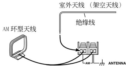
AM 室外天线水平安装在户外，接收的效果最好。但是有时水平安装在室内窗户的上方也能收到好的效果。注意 AM 环型天线要保持连接。为防止雷电击，室外天线必须按照规定接地。
