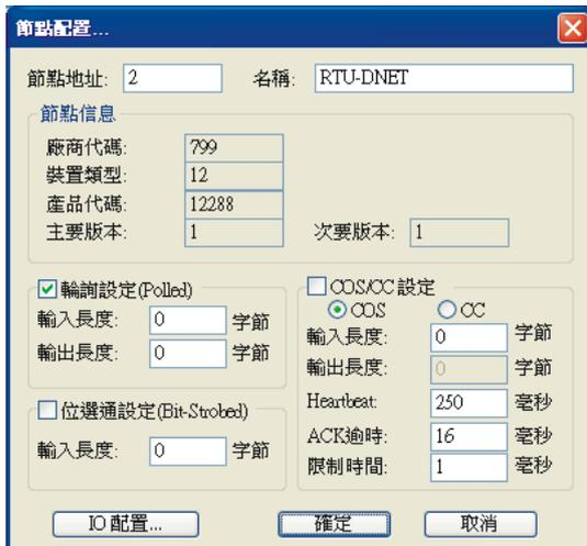
(8) 单击“IO 配置...”按钮，弹出“RTU 配置”界面，如图所示：
