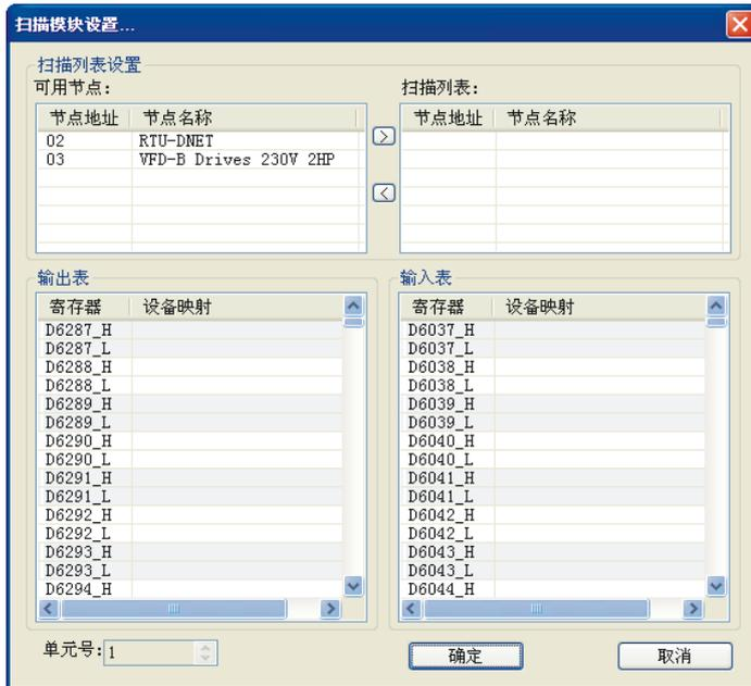
(2) 将上图中左边列表中的 DeviceNet 从站设备移入 扫描模块的扫描列表中。具体步骤为：选中 DeviceNet 从站节点，然后点击"", 如下图所示。按照此步骤，即可将 DeviceNet 从站节点依次移入到扫描模块的扫描列表内。
