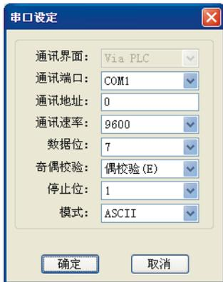
(3) 在此对 PC 与 SV 主机的通讯参数进行设置。如”串口”、”通讯地址”、”通讯速率”、”通讯格式”
