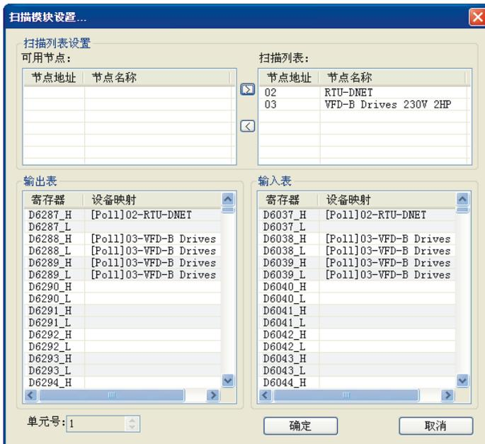
(3) 确认无误后，点击“确定”，然后将配置下载到 DVPDNET-SL 扫描模块内。下载时，如果 SV 主机处于运行模式，会弹出“警告”对话框，如图所示：
