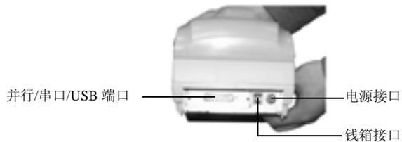
图 2-2 打印机接口图
