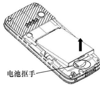
**警告：**拆卸电池之前一定要将手机关机。绝对禁止在开机的情况下直接取出电池，否则可能损坏 SIM 卡和手机。
