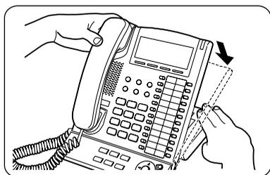
**2** 接上电话连接线，然后先安装墙壁固定转接器的 ①，再安装墙壁固定转接器的 ②。
