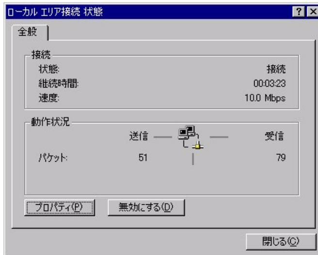
2. 「プロパティ」をクリックし、「インターネットプロトコル (TCP / IP)」のチェックボックスがチェックされていることを確認してください。チェックされていない場合は、チェックしてください。
