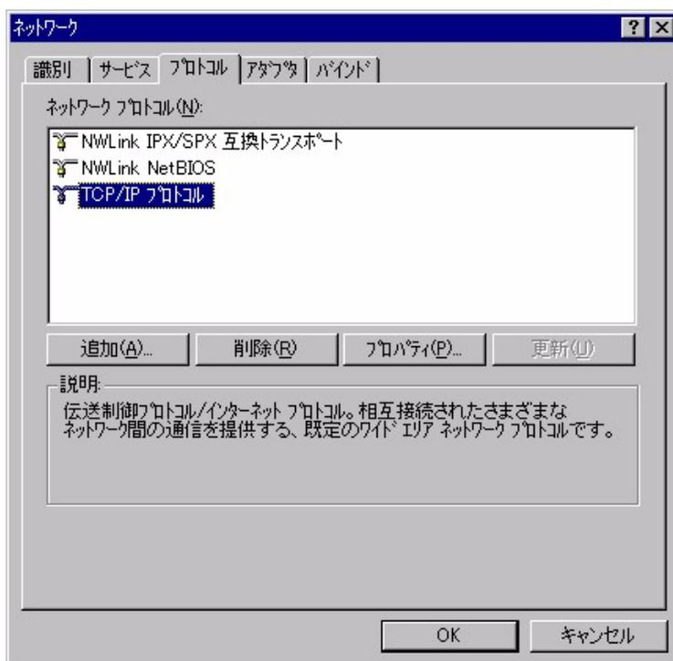
2. TCP / IP プロトコルを選択し、「OK」をクリックします。
