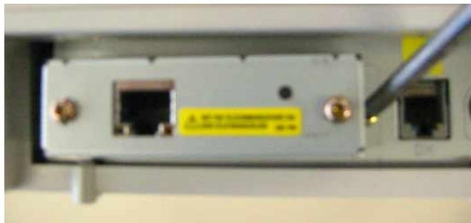
4. 取り付けした UB-E02 の 10Base-T/100Base-TX イーサネットコネクタに、10Base-T/100Base-TX ケーブルをカチッという音がするまで押し込みます。
