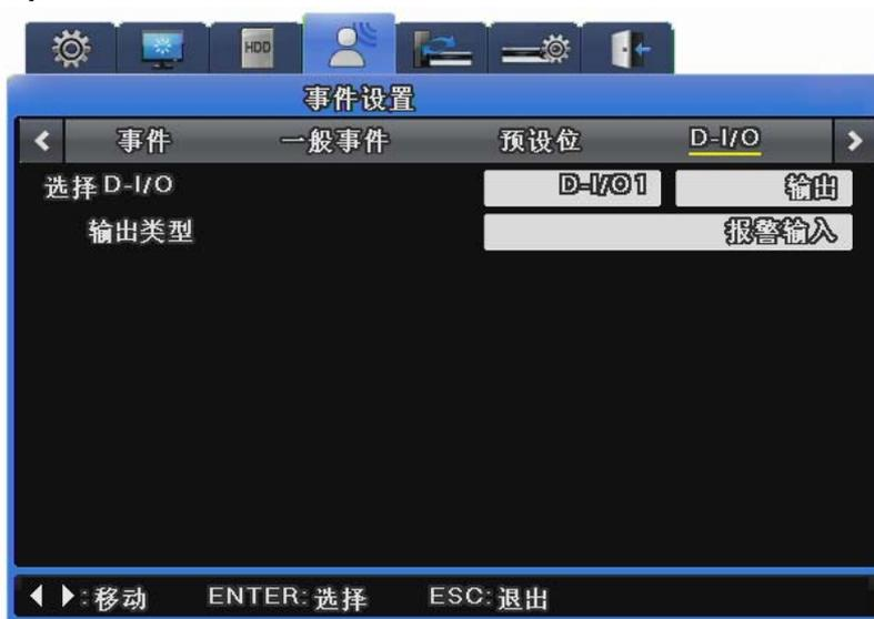
数字 D-I/O 是同时为输入和输出提供的数字端口，共有 12 个数字输入和输出。
