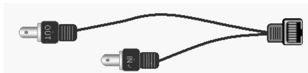
图 2-7 RJ48C 接口与 BNC 接口的转换
