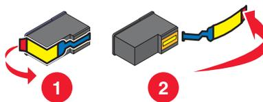
**警告：**请不要用手触摸打印墨盒后面的金色触点区域或打印墨盒底部的金属喷头区域。
