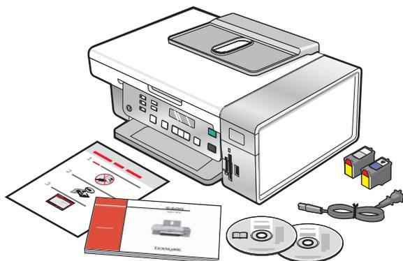
2 检查顶部、底部、两边、纸张托盘和出纸托盘，请确认从打印机上完全撕掉了所有的胶条和包装材料。
