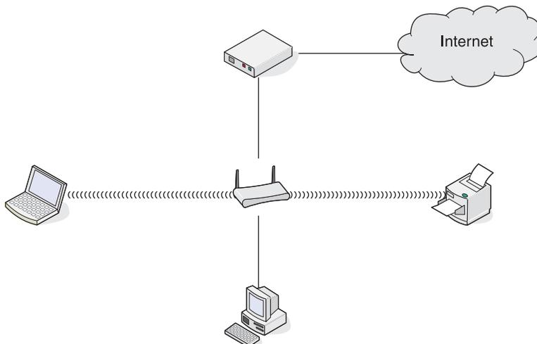
方法 2：计算机、便携式笔记本电脑和打印机都通过无线连接，可以连接到 Internet
