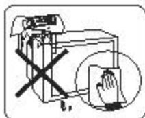
勿用酒精、氨水、稀碱剂等清洗电视机表面，若确有需要，请用海绵或软布(可加少量中性洗涤剂)的干布清洗，并切记在清洗前切断电源。
