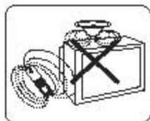
电视机应远离强声源、电动机、变压器等磁性物品，以免引起彩色异常。
