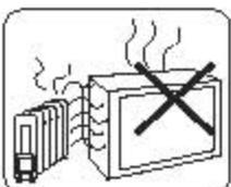
机内温度过高易引起电视机损坏，应保证电视机通风良好，如新增挡电视机散热孔。电视机应远离热源(如：暖气、火炉等)处，并避免阳光直射。
