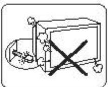
电视机使用中发觉异常(如有异味等)或不慎将异物落入机内，应立即关闭电视机并拔出插头，尽快与保修单位联系检修。
