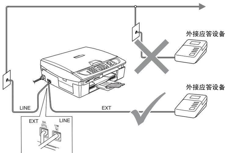
使用外接应答设备时，屏幕显示 Telephone（电话）。
