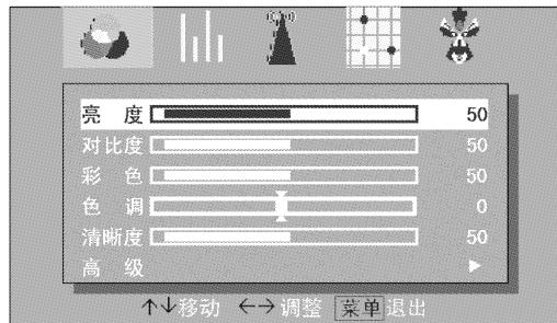
注：“色调”项只有在 NTSC 制式下才出现。在 YCbCr 状态下，无“色调”项；在 YPbPr(HD)或 VGA(PC)状态下，无“色调”项和“清晰度”项。
