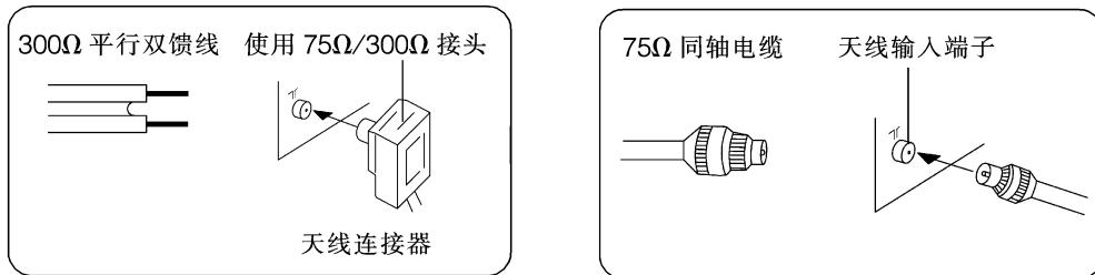
注:① 建议您最好使用 75Ω 同轴电缆,以消除因阻抗不匹配导致的杂波和干扰。
