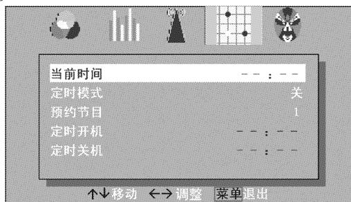
注:① 在开机状态下,如定时开机时间到,则转到设定的预约节目,实现定时换台和提醒的功能。
