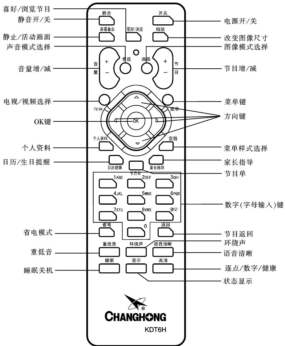
注：①操作时，请将遥控器对准电视机遥控接收窗。
