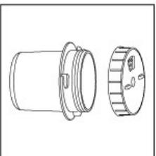
4.卸下干磨刀座后，可直接将产品自带的撒粉盖旋紧在干磨杯上，按撒粉盖上的“开”和“关”调节使用。
