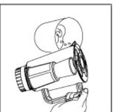
6. 加工完成，将旋钮开关旋至“0”出，拔下电源，将搅拌杯从主体上卸下，取下搅拌杯盖，不要松动滤网。
