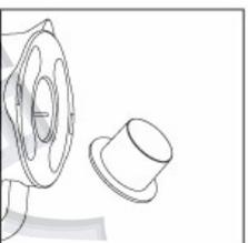
3. 用量杯量取要加工的固体食材，通过杯盖上的加料口放入过滤网，注意加入食材的量不要超过最大刻度。如果是做豆浆，放入浸泡后的湿豆每次最多两平杯（60克以内），加水至刻度线400ml以下。
