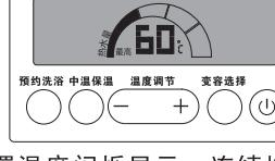
2. 温度设定：按“温度调节”键，设置温度闪烁显示，连续按压“+”键为35℃~75℃之间循环显示，按压“-”键为75℃~35℃之间循环显示，不操作约6秒系统自动确认设置。如下图，机器处在即时加热模式，调整机器设置温度为65℃。
