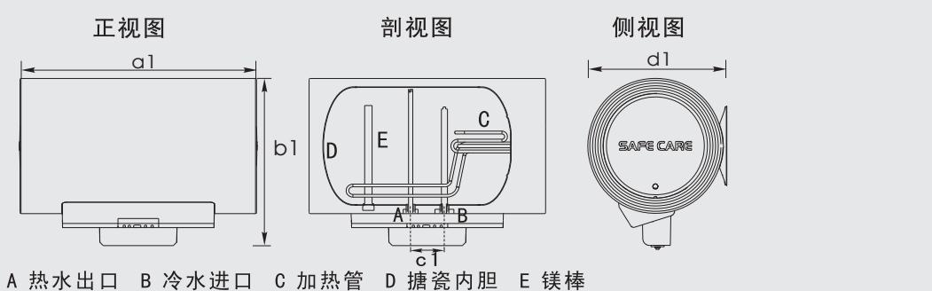
A 热水出口 B 冷水进口 C 加热管 D 搪瓷内胆 E 镁棒
