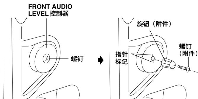
卸下位于 FRONT AUDIO LEVEL 控制中央的螺钉，使用同一个螺钉（附件）把附件旋钮安装到控制器和本机上。请确保旋钮侧的指针标记与控制侧的指针标记对齐。
