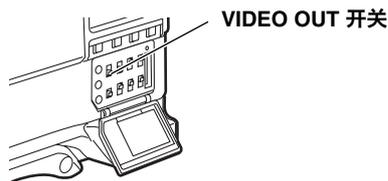
使用 VIDEO OUT OUTPUT SEL 开关切换 VIDEO OUT 接口输出的信号。
