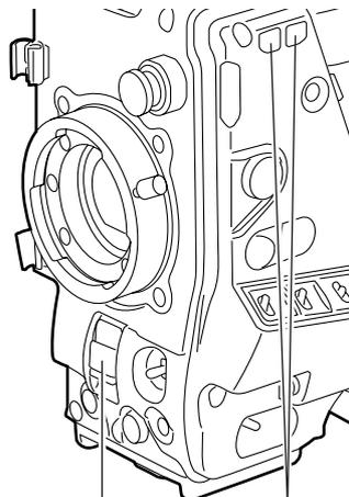
**2** 在 SYNCHRO SCAN 模式下, 操作 SYNCHRO SCAN (+ 和 -) 键可以连续更改快门速度。
