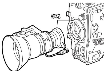
3 推下镜头固定杆紧固镜头。
