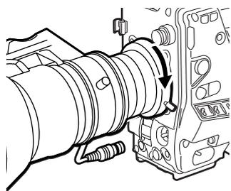
4 将电缆推入电缆夹，并将其与 LENS 插座相连。
