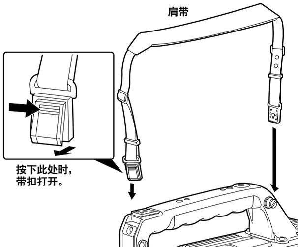
要拆下肩带，请打开安装部分的带扣，肩带就可拆下。
