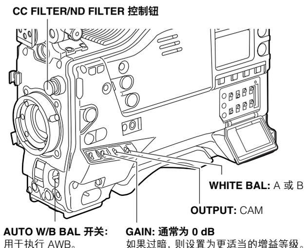
**2** 根据照明条件，选择 CC FILTER/ND FILTER 控制钮设置。
