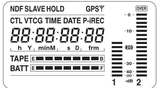
寻像器中的音频电平计显示
