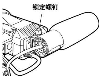
**3** 将麦克风连接电缆与摄像机的 MIC IN 插孔相连。
