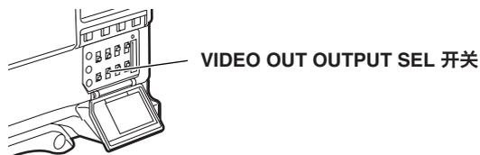
使用 VIDEO OUT CHARACTER 开关和菜单上的 OUTPUT ITEM 项目（SYSTEM SETTING 页上的 <OUTPUT SEL> 屏幕）在 VIDEO OUT 接口输出的信号上设置要叠加的字符。
