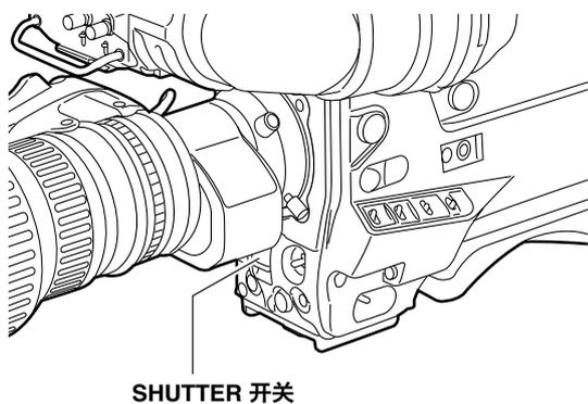
**2** 再次将 SHUTTER 开关按至 SEL 位置, 然后重复此操作直至所需的模式或速度显示。当所有模式和速度均显示时, 显示将按以下顺序更改。
