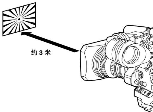
3 设置照明，以便在离后截距调节用的图板 3 米远的地方获得合适的视频输出电平。
