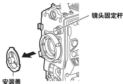
2 使用镜头固定环顶部中央凹槽将镜头的中心标记对准并安装镜头。
