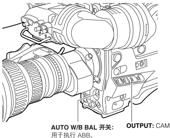
**2** 将 AUTO W/B BAL 开关设置为 ABB 位置，然后释放开关。
