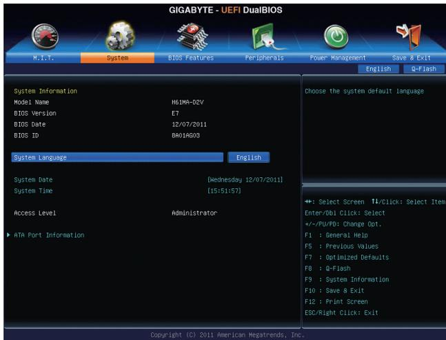
이 마더보드 모델, BIOS 버전에 관한 정보를 제공합니다. 또한 BIOS에 사용할 기본 언어를 선택하고 시스템 시간을 수동으로 설정할 수 있습니다.
