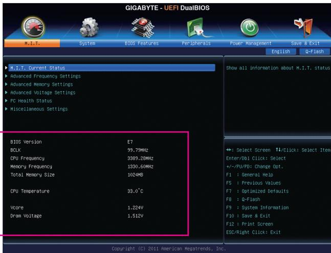
이 섹션은 BIOS 버전, CPU 베이스 클럭, CPU 주파수, 메모리 주파수, 총 메모리 크기, CPU 온도, Vcore, 메모리 전압에 대한 정보를 제공합니다.
