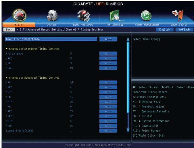
하위 메뉴는 각 채널 메모리의 메모리 타이밍 설정을 제공합니다. 관련 타이밍 설정 화면은 DRAM Timing Selectable 이 Quick 또는 Expert로 설정된 경우에만 구성할 수 있습니다. 주: 메모리 타이밍을 변경한 후에는 시스템이 불안정하거나 부팅 시 오류가 발생할 수 있습니다. 이런 경우 최적값을 로딩하여 기본 값으로 보드를 재설정하거나 CMOS 값을 삭제하십시오.
