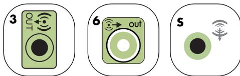
**3** 将后置扬声器电缆连接到电脑背面相应的黑色接口。
