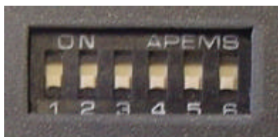
图 15-6 编码器模板的 DIP 开关
