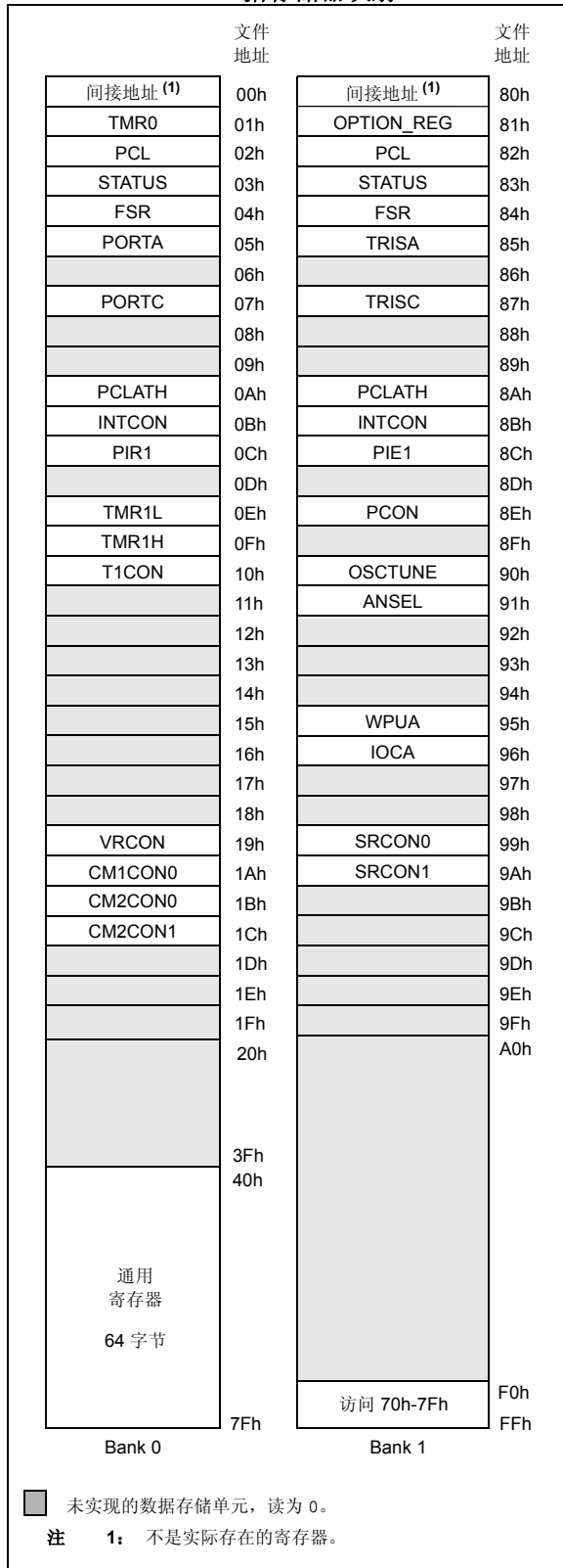
图 2-3: PIC16F610/16HV610 的数据存储器映射
