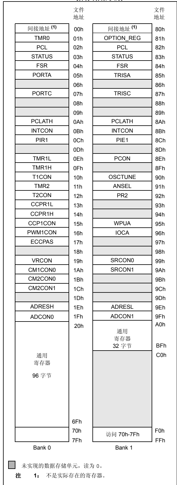
图 2-4: PIC16F616/16HV616 的数据存储器映射
