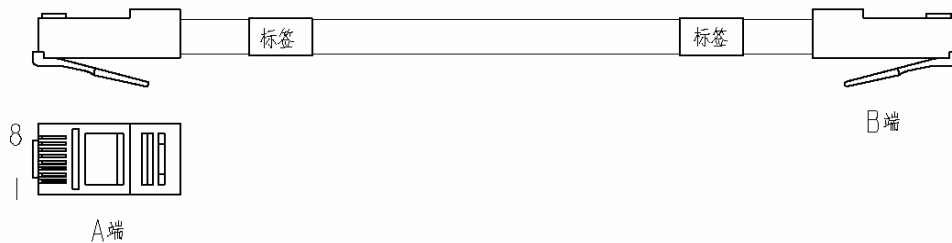
图6.3-1 两端压接 RJ45 插头的网线结构示意图
