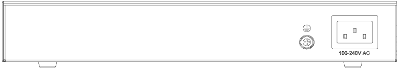
图1-2 S1208 以太网交换机后面板示意图
