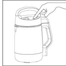
请将机头按正确的位罝放入杯体中，插上电源线，指示灯全亮，按果汁功能键，这时果汁功能对应图形指示灯亮，同时启动该功能程序。
