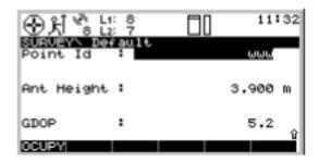
8. 此时接着按终端上的(ESC)键,将出现如下屏面,接着按 F5 (OK),回到主菜单。
