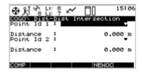
在以上菜单中输入两点的坐标,以及两个距离的值。按 COMP 计算求结果如下:
