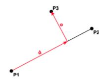
Distance 为点 P3 到射线的距离,若点在射线的右边,为正;若点在射线的左边,为负;Perp.Dist 为点 P1 到点 P3 在线上的投影点的距离,若投影点在点 P1 的前方,为正,若投影点在点 P1 的后方,为负。
