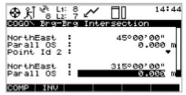
在上述菜单中输入 P1 和 P2 的点标识及坐标、角度、平行线的间距。按 F1 键进行计算交会点的坐标。
