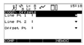
输入线上的 P1、P2 两点坐标或按 NEWOC 键采集这两个点,接着输入偏差点 P3。按 COMP 得出计算结果。
