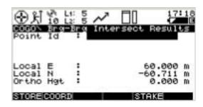
以上菜单中显示的是交会点的三维坐标,按 F1 键存储有关信息。具体的点、距离及角度的 关系如下图所示:
