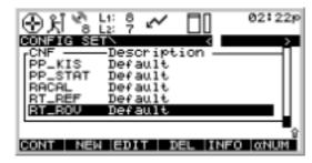
2. 将光标调到如上位置(RT-ROV)后,按 F2(NEW),相当于将 RT-ROV 复制一个新配置集。
