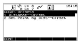
1 Distance—offset 程序的功能为输入两个点,确定一条射线;另外输入一点,并求该点到射线的距离及该点在线上的投影点到射线的起始点之间的距离。
