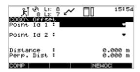
在上述屏面中输入确定射线的两个点的点标识及三维坐标或用 F5 键进行测量新的点,并输入相应的偏差距离(其中关于距离的符号与子程序 1 中的符号一致)。按 COMP 键计算结果如下:
