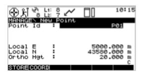
将点的信息输入完毕后,按F1STORE,存储点的信息,屏幕将返回到第三步所示的屏面, 并显示你输入的点的简要信息:
