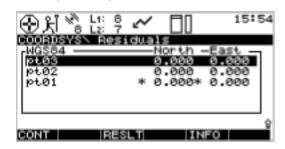
6. 上面的为残差,如果对结果比较满意,按 F1(CONT),这时显示的为转换参数的值。按 F1(CONT) 回到主菜单,则当地坐标系统已经建好。一旦坐标系统建好,则系统自动默认为当前的系统。如果你的 GPS 上有两个以上的当地坐标系统(如 54 和 80),则需要在工作时进行选择。方法为:在主菜单下进入测量或放样菜单,然后使用 F6(CSYS)。
