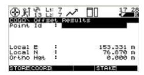
显示点的坐标,为该点输入点标识,按 F1 键存储坐标信息、F6 键放样该点。
