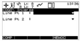
在上图中,输入点 Pt1 和 Pt2 的点号,若仪器内存在该点,则自动调出;同样也可用 F5 键进行测量新的点。按 F1 键计算结果:
