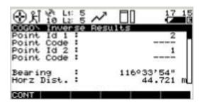
结果显示两点间的水平距离 D 及高差 H;射线 Pt1-Pt2 与北方向的夹角,具体的表示如下图所示:
