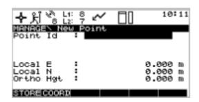
5. 输入待放样的点的信息: 点名,如 P01; 输入 Local E 东坐标 (即 y); Local N 北坐标 (即 x), ortho Hgt 正高 (即 h), 如下图所示:
