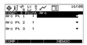
如图所示,在上述屏面中输入 P1、P2、P3 三个点的坐标或使用 F5 NEWOC 键测三个新点,按 F1 COMP 键将显示圆心坐标。如下图所示:
