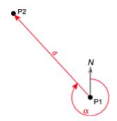
2. Traverse 的功能为通过输入一个起始点的坐标及相关的距离和方位角等,计算一个新点的坐标。
