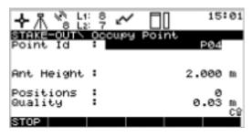
等采集了3至5个历元时,按F1STOP停止测量,再按一次F1STORE,存储采集的点。 屏幕返回放样主屏面。此时待放样的点直接跳到下一个点。
