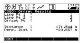
具体步骤为:输入 P1、P2、P3 三个点,P1 点、P2 点确定一条射线;输出 P3 点与射线的偏距及 P3 点在线上与 P1 点的偏距。图形表示如下:
