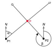
左图显示的部分为 Parall os 即平行线间的距离为 0 时的交点。若 Parall os 不为 0 时,所求的点为与这两条直线相平行的直线(间距为所输入的值)的交点。同样,若 Parall os 为正,则为右侧的直线:若为负,则为左侧的直线
