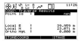
以上菜单显示所求点的三维地方坐标。给点输入一个点标识,则按 F1 键保存点标识及坐标等信息; F2 键进行不同坐标系统间的坐标转换; F5 键将该点在实地上放样出来。
