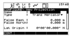
输入名称(如 GAUSS),选择类型(Trans Mercator),输入平移量、中央子午线、带宽。然后 F1(CONT),再按 F1 回到原来的屏幕。
