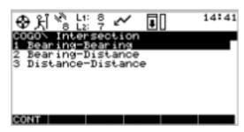
将光标打在 1 Bearing – Brearing(方位—方位)按 CONT,进入角与角交会程序如下图所示:
