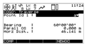
即输入一个点号 a,a 为一个已知点,其坐标值为(N0; E0; H0)(或用实际测量点),在相同的地方格网坐标下计算。输入有关的方位角,平行线间距,及距离 D。
