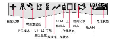
注: 图标的出现与否取决于所使用的接收机为系统 500 的哪种类型,接收机的定位模式以及所作的配置。
