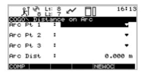
在上述屏面中输入三个点的点标识及坐标,也可按 F5 NEWOC 键测量三个新点,并输入 距离 D: 按 F1 COMP 键进行计算点的坐标。如下图所示:
