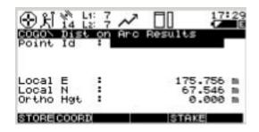
上述屏面中显示点的坐标,按 F1 键存储该点, F5 键可以将该点放样出来。
