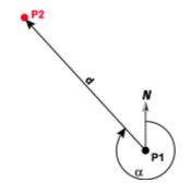
左图表示 parall os 的情况。点 P1 的坐标为(0,0,0),Parall os 表示为图中的 O-P2 的距离,Horz Dist 表示为图中的 P1-O 距离。程序中若 parall os 为正,则表示点的位置是垂直偏离图中点 P2 的右方向,且距离为parall os 的值;若 parall os 为负,则表示点的位置是垂直偏离图中点 P2 的左方向,且距离为parall os 的值。注意:若程序 2Traverse 中的 Parall Os 为零时,程序为由已知的点及相应的夹角与两点间距离,求一未知点的坐标。是相对于 Invrese 的由两已知点的坐标求夹角与距离的程序反算。
