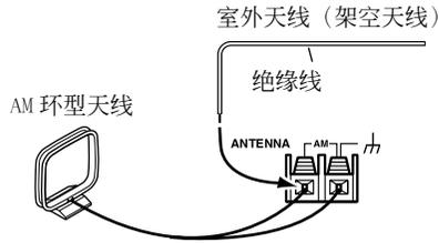
AM 室外天线水平安装在户外，接收的效果最好。但是有时水平安装在室内窗户的上方也能收到好的效果。注意 AM 环型天线要保持连接。
