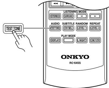
各扬声器将轮流输出测试音，显示屏上同时出现各扬声器的名称。要关闭测试音，再次按下 [TEST TONE] 键即可。
