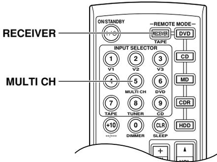
多信号输入模式用于连接视听设备和独立的 5.1 信号模拟输出，如 DVD 播放机或 MPEG 解码器。参见 25 页有关设备连接的信息。
