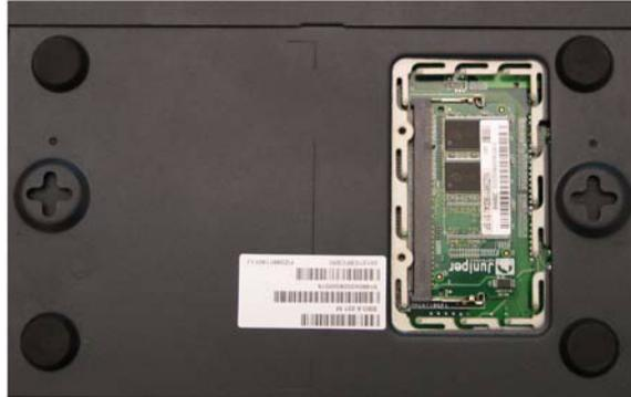
6. 用拇指按住模块两边的锁定装置向外轻推，使这些锁定装置与模块分离，从而取下 128 MB DIMM DRAM。
