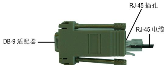
2. 将 RJ-45 CAT5 串行电缆的凸端插入 SSG 5 的控制台端口。(确保将 CAT5 电缆的另一端正确插入并固定在 DB-9 适配器中。)
