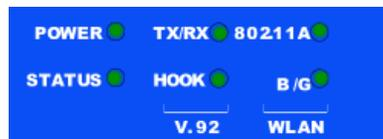
启动系统后，POWER LED 从关闭状态变为闪烁绿色状态，而 STATUS LED 则按以下顺序发生变化：红色、绿色、闪烁绿色。完成启动这一过程大约需要两分钟时间。如果要在关闭系统后重新启动系统，建议在关闭之后和重新启动之前稍候几秒。表 2 提供了各系统状态 LED 的类型、名称、颜色、状态和说明。
