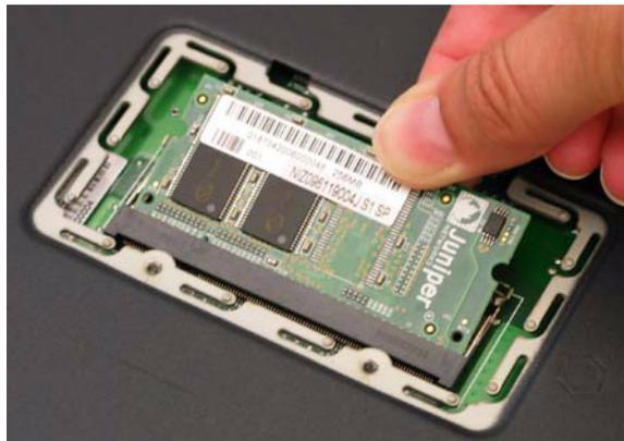
8. 将 256 MB DIMM DRAM 插入插槽。用两个拇指对模块上边缘均匀施力，然后向下按压模块直到锁定装置发出“咔”的一声入位。
