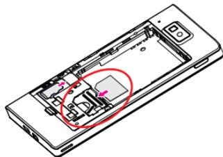
5. 插入电池。请确定电池触点与电池槽内的接点对齐。
