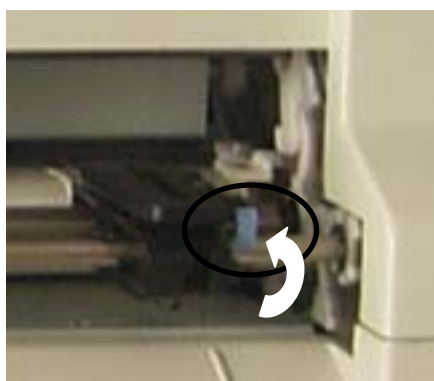
图 3-8 松开链轮锁定杆
