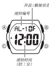
本表配备有 5 个可单独使用的每日闹铃。闹铃经开启后，本表在到达预设的闹铃时间时会发出闹铃音。五个闹铃中一个为间歇闹铃，而其他四个为一次鸣响闹铃。您还可以开启整点响报功能，使本表在每小时正点鸣音两次。
