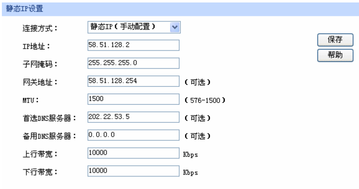
图 5-4 WAN 口设置静态 IP 连接方式
