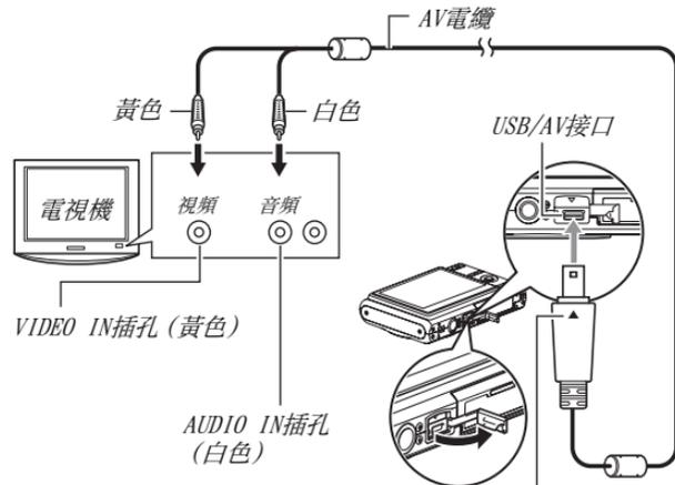
確認相機上的▼標記已對準AV電纜插頭的▲標記，將電纜連接到相機上。
