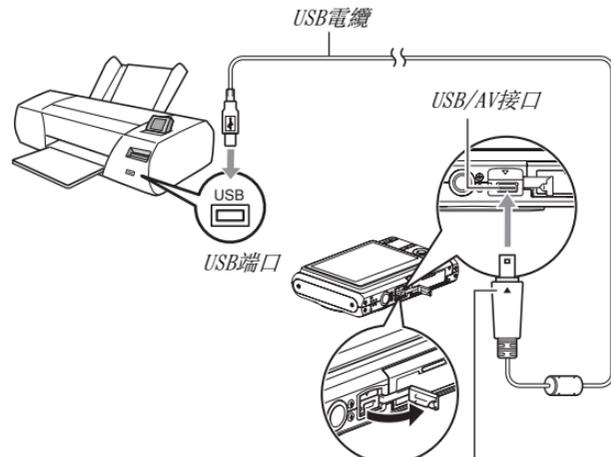
確認相機上的▼標記已對準USB電纜插頭的▲標記，將電纜連接到相機上。
