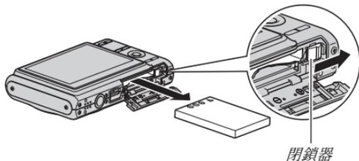
3. 在按住閉鎖器的同時，將電池完全拉出。
