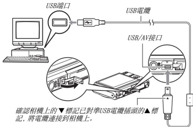
確認相機上的 ▼ 標記已對準USB電纜插頭的▲標記，將電纜連接到相機上。
