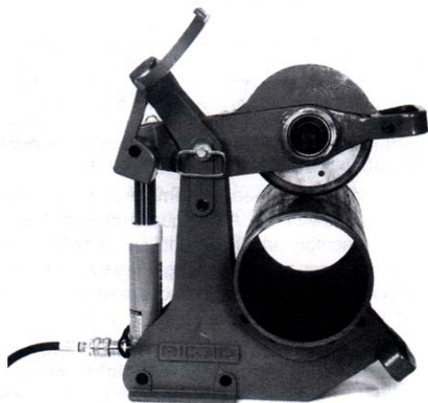
图 9—管子在割管机上就位。
