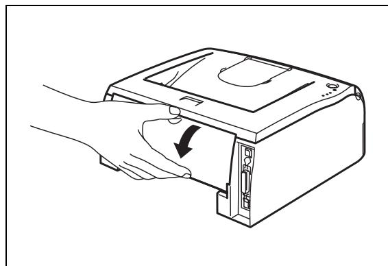
6 将滑块朝身体方向拉出打开后部斜槽盖。
