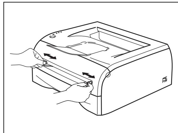
5 用双手将一张纸或一个信封放入手动进纸槽中，直到纸张或信封前端边缘触到进纸辊。感到设备自动卷入纸张一小部分后，请松手让纸张自动进入设备。
