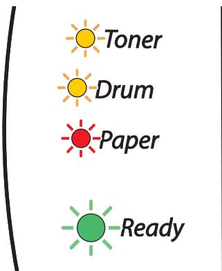
如果想看到以上的维修呼叫指示，关闭电源开关，等待几分钟，然后重新打开，并重新打印。
