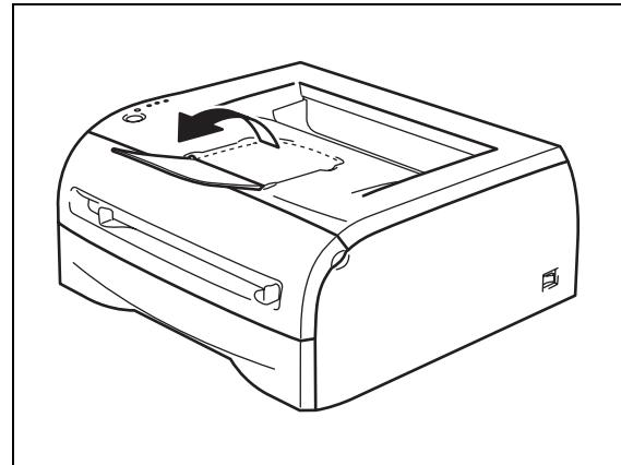
4 用双手滑动手动进纸槽导纸板以适合将要使用纸张的宽度。
