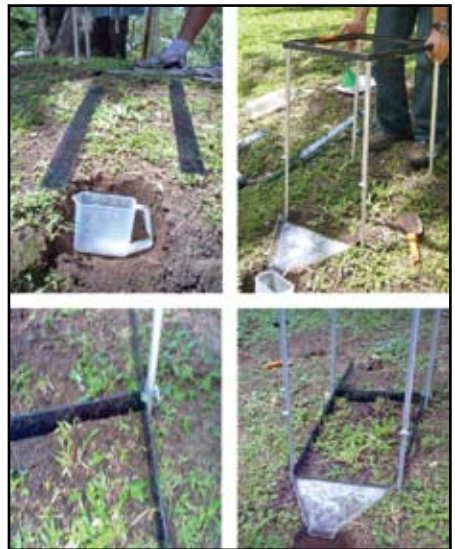
Figura 5. Instalación del simulador de lluvia en el campo (Monge, 2007)
