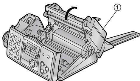
4 将前印字薄膜辊蓝芯的齿轮件 (1) 插入到机器的左插槽中 (2)。
