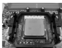
步骤 4： 下推并锁住插座拉杆
