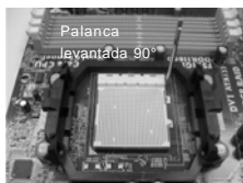
PASO 1: Levante la Palanca del Zócalo
