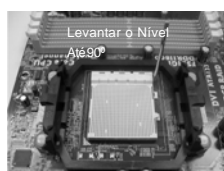
PASSO 1: Levantar o Nível de Tomada Até 90°
