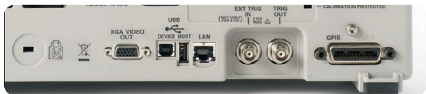
图 7. 5000 系列没有 RS-232。但是它具备您可能需要的所有其他标准接口。
