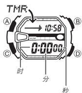
倒数计时器可在 1 分钟至 24 小时的范围内进行设定。当倒数到达零时，闹铃会鸣响。本倒数计时器还具备自动重复功能及可通知倒数进度的进度响报。
