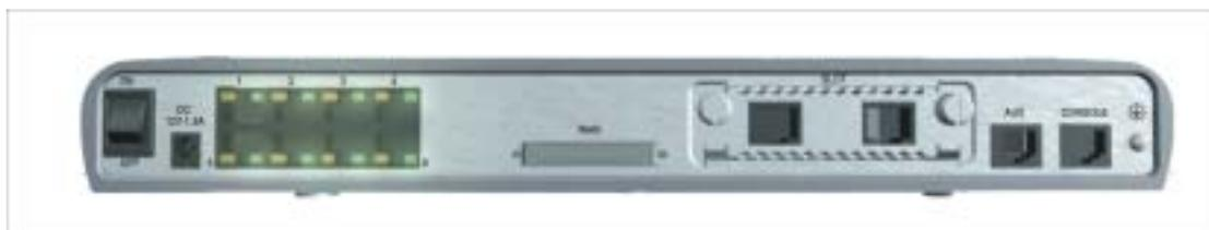
图 1-4 NetHammer M128 &amp; M128-VPN 后面板
