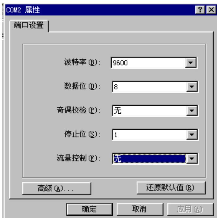
图 6-4 设置端口通讯参数
