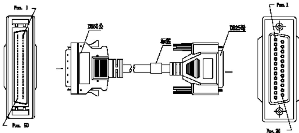
图 9-4 EIA-232 ( V.24 ) DCE 电缆
