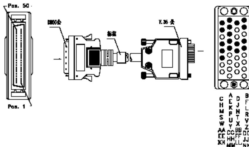
图 9-5 V.35 DTE 电缆
