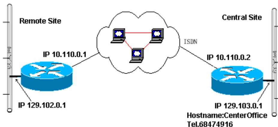
图 6-12 ISDN BRI 接口上运行 IP 协议示例组网图
