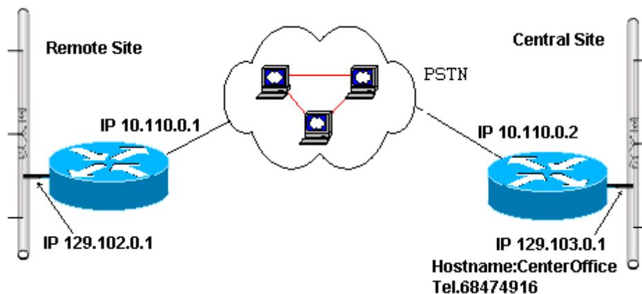
图 6-14 AM 接口上运行 IP 协议示例组网图
