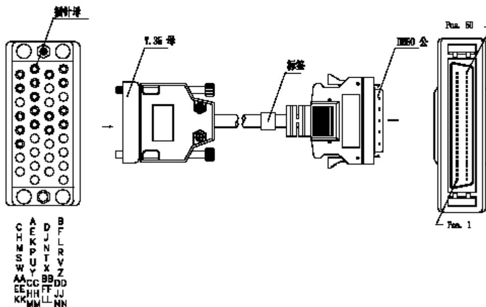
图 9-6 V.35 DCE 电缆
