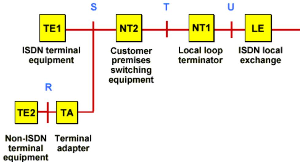
图 6-10 ISDN 网络中的设备类型和参考点
