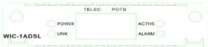
图 2-6 WIC-1ADSL 模块面板示意图
