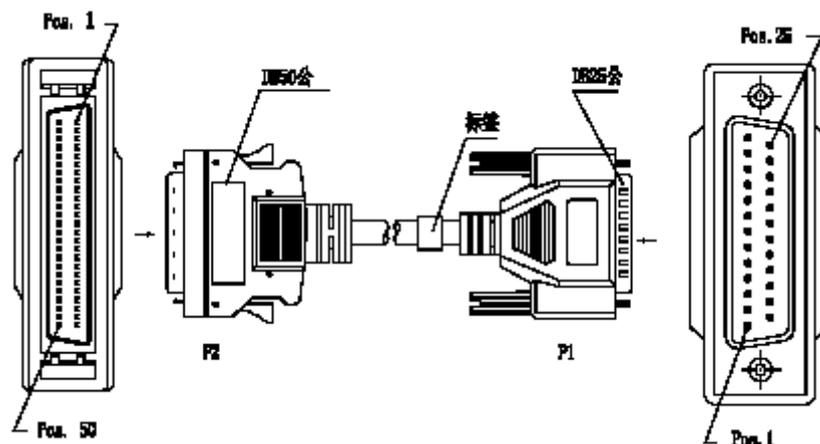
图 9-3 EIA-232 ( V.24 ) DTE 电缆
