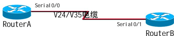
图 6-16 两台路由器通过串口直连(X.25)
