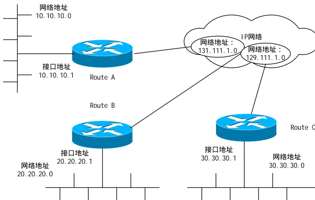
图 6-9 以太网配置举例组网图
