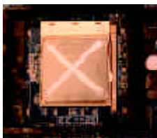
圖 4.塗抹散熱膏於處理器上
