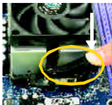
圖 5&6 將散熱風扇裝置配件一一組合
