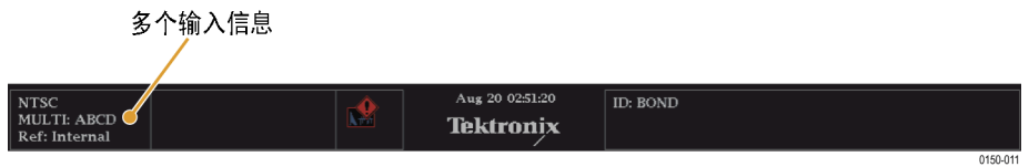
图 4: 多输入模式下的状态栏
