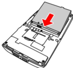
7. 后壳上的钩与设备上的孔对准，关闭后盖。
