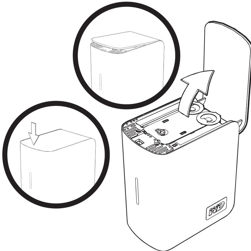
3. 松开固定驱动器机盖的指旋螺丝。卸下驱动器机盖并放在一边。
