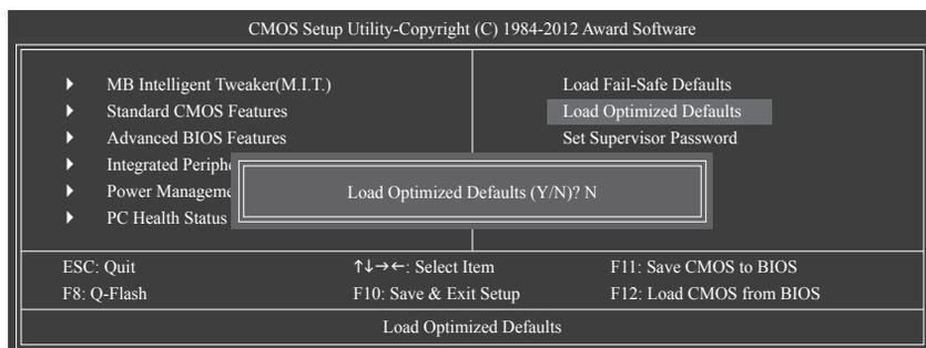
在此選項按<Enter>然後再按<Y>鍵，即可載入BIOS出廠預設值。執行此功能可載入BIOS的最佳化預設值。此設定值較能發揮主機板的運作效能。在更新BIOS或清除CMOS資料後，請務必執行此功能。
