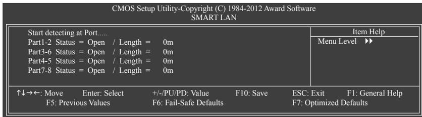
本主機板具備網路線偵測功能，幫助使用者可以在BIOS中確認目前網路連接情況是否正常，若線路故障時亦可回報故障位置。
