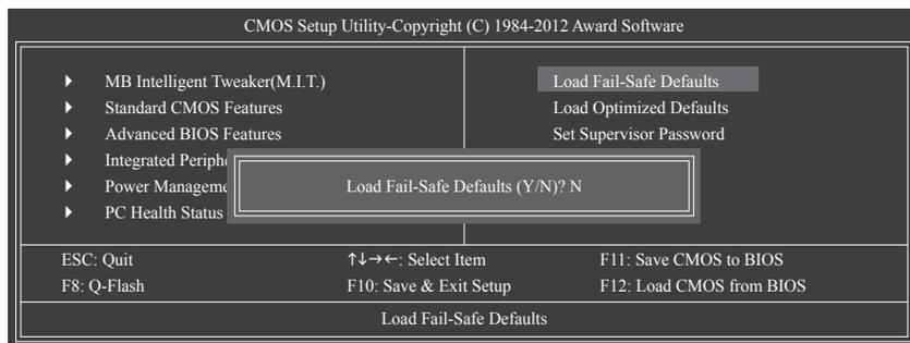
在此選項按<Enter>然後再按<Y>鍵，即可載入BIOS最安全預設值。如果系統出現不穩定的情況，可嘗試載入最安全預設值。此設定值為最安全、最穩定的BIOS設定值。
