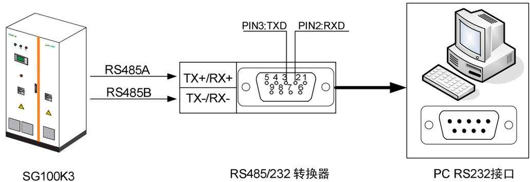
图8-10 通过 RS485/RS232 转换器与电脑连接
