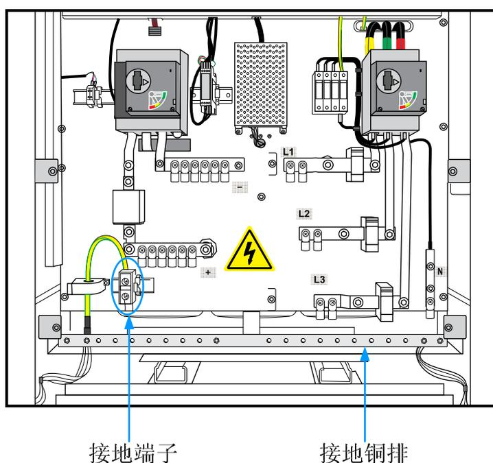
图8-8 接地铜排示意图
