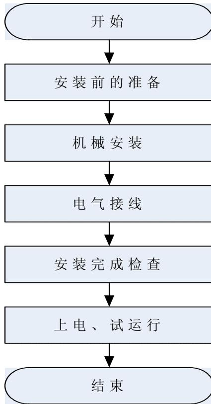
图5-3 安装流程
