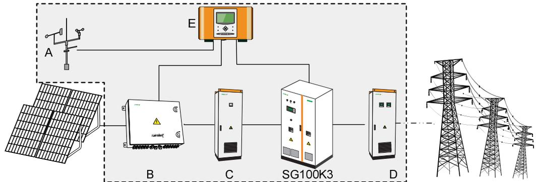
图5-1 光伏并网发电系统可选配置
