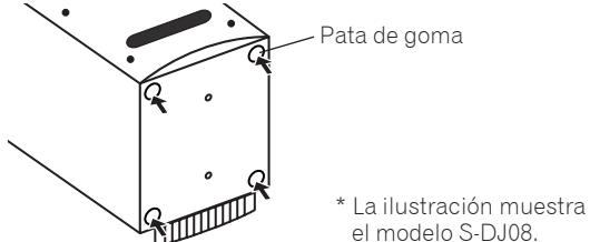
Las patas de goma suministrada pueden utilizarse según los requisitos de la instalación. Coloque una pata de goma en cada esquina de la parte inferior del altavoz. Tenga presente que las patas de goma pueden causar insuficiente resistencia al deslizamiento en algunos lugares, por lo que no deberán utilizarse sobre superficies resbaladizas.
