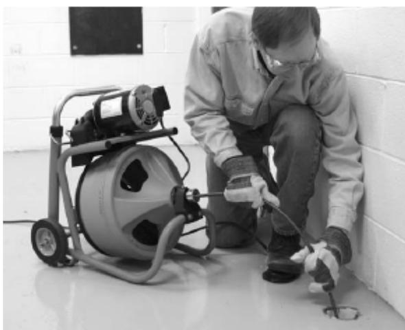
图12 — 正确的手动进索操作姿势示例
