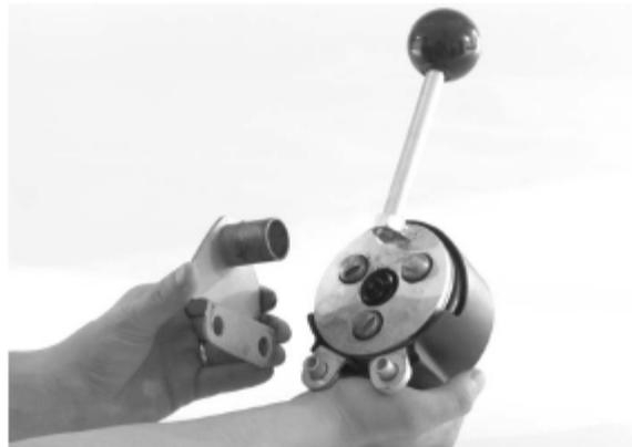
图3 — 安装固定支架到自动进索机构背部
