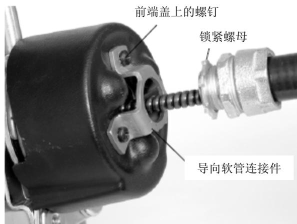
图5 — 安装导向软管至自动进索机构
