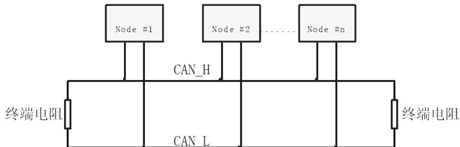
图 3.4 CAN 网络结构
