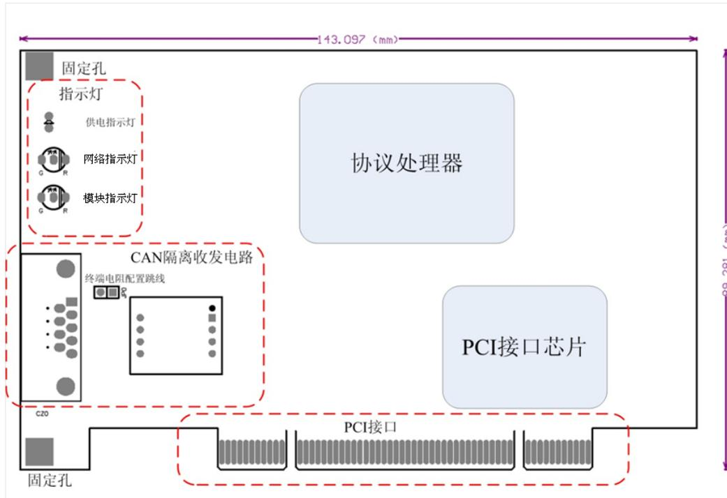
图 3.1 PCI-5010-D 结构框图
